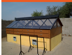
Un séchoir mixte (solaire et gaz) polyvalent
